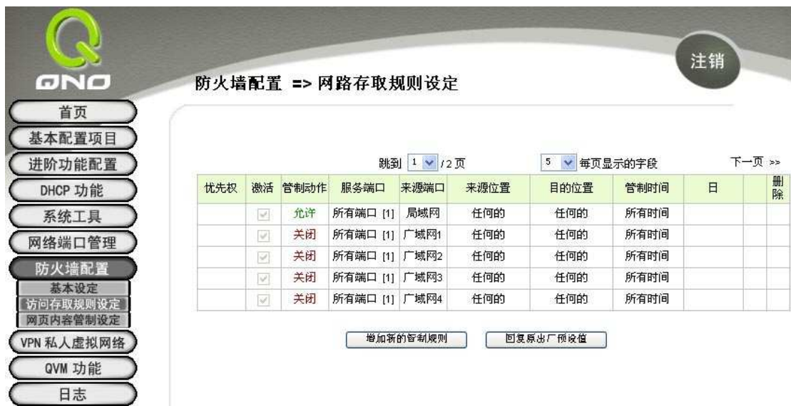
图一：访问规则设置，是最基本阻挡不必要存取的基本工具。对于使用公网 IP 的服务器，更是必须设置的基本项目。减少存取不但可以降低路由器的工作负担，更可增加内网的安全性。
