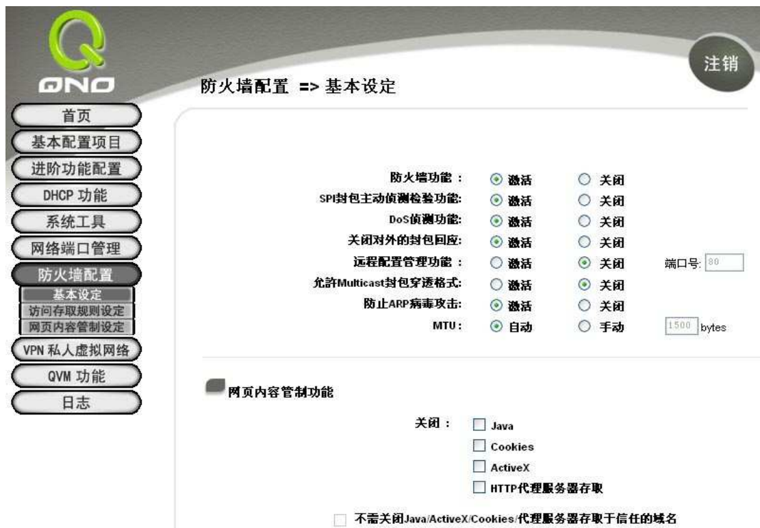
图五：Qno 侠诺路由器的基本配置功能可让网管选择是否开启一些常见的服务，取得路由器效能及安全之间的平衡。
